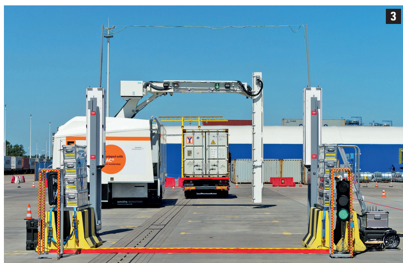
Fot. 4 System CANIS prześwietla wagony kolejowe wjeżdżające na teren Unii Europejskiej
