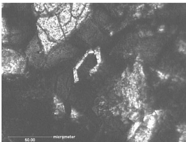
Fot. 3. Żużel po hutnictwie rud Zn-Pb; pirokseny na tle szkliwa; analiza mikroskopowa w świetle przechodzącym, 400×, 1N (Jonczy 2006)
