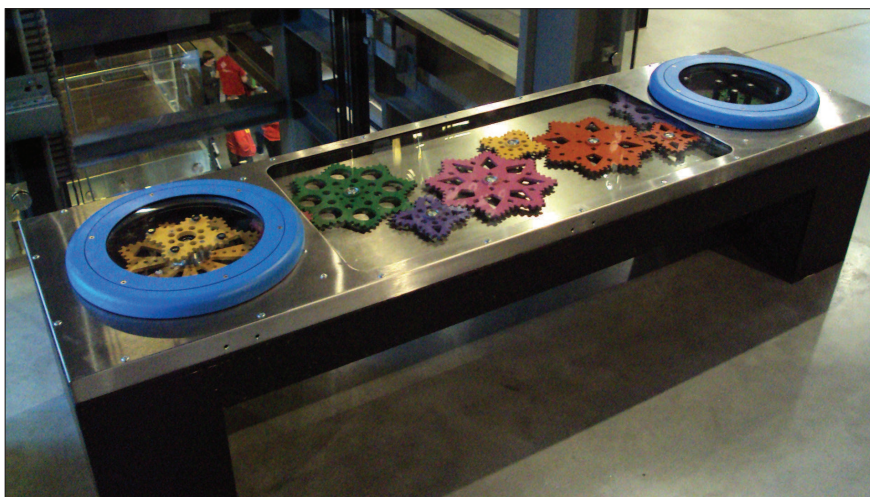
1. „Trybiki” – układ 10 nieokrągłych zębatek (fot. Agnieszka Piwnik) 1. “Cogwheels” – an arrangement of 10 non-circular gears (photo by Agnieszka Piwnik)
