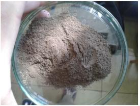
Fig. 4. Powdered flash slag
