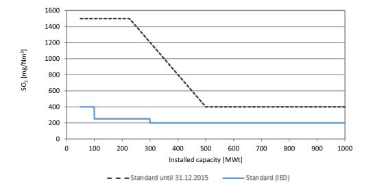
Fig. 1. SO<sub>2</sub> emission standards for hard coal-fired plants (Directive 2010)Rys. 1. Limity w zakresie emisji SO<sub>2</sub> dla źródeł na węglu kamiennym
