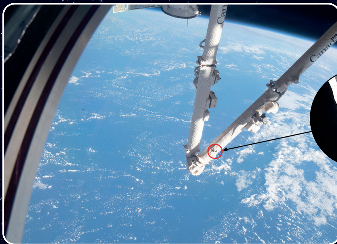
Ramię robotyczne Canadarm2 przedziurawione śmieciem kosmicznym, NASA
