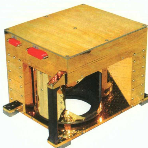
Skaner Planetarnego Spektrometru Fouriera (PFS) znajdujący się na pokładzie sondy Mars Express
