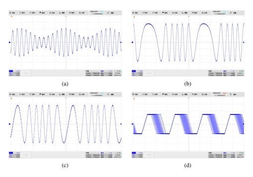
Fig. 21. (a) Amplitude modulation, (b) frequency modulation, (c) phase modulation, (d) PWM.
