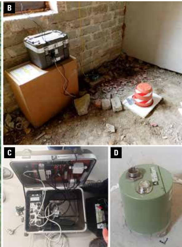
Lokalizacja i konfiguracja stacji sejsmicznych: A) Lokalizację stacji. B) Stacja w miejscu po rozmieszczeniu. C) Części stacji, takie jak digitizer i router. D) Czujnik
