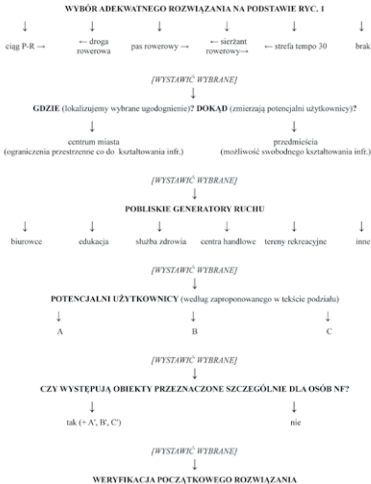
Ryc. 4a. Zaproponowana metoda wyboru udogodnienia przydatnego dla wszystkich grup rowerzystów
