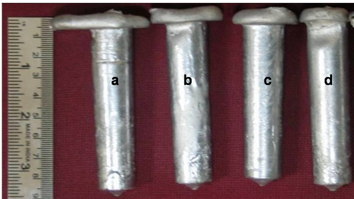
Fig. 1. Photograph of matrix alloy (a) and zircon reinforced composites (b) 3 v % (c) 6 v % and (d) 9 v %
