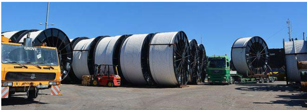
Fot. 2. Rolki z nawiniętym rurociągiem (przeciętny ciężar każdej z 21 dostarczonych w ostatnim transporcie rolek to 50 ton – 2–2,2 km gazociągu) tuż po wyładowaniu transportu z Houston do Gdańska (łącznie zakupiono 53 rolki)
