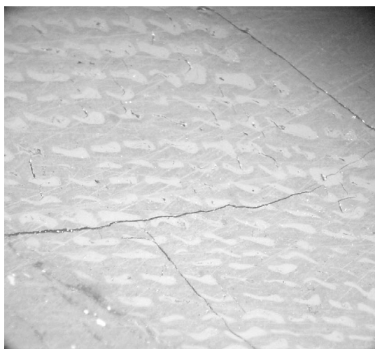
Rys. 2. Macerał z grupy wityrnytu: telinit, światło białe odbite w immersji olejowej, pow. \times 50
