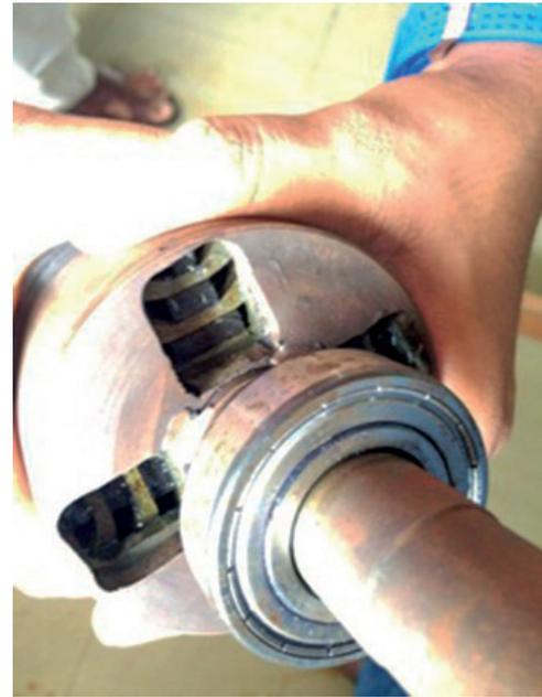
Fig. 4. PMASR motor rotor
