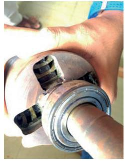
Fig. 4. PMASR motor rotor
