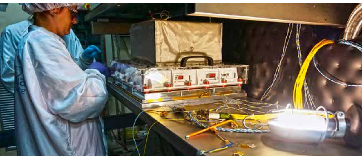
Detektor POLAR podczas testów termicznych w laboratorium w Terni, Włochy
