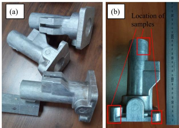
Fig. 1. Casting “body”
