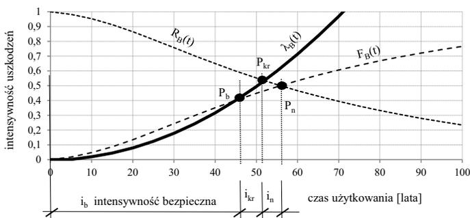
Rys. 1. Zmiany intensywności uszkodzeń w budynku nieremontowanym
