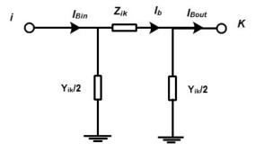
Fig. 3. Pi-equivalent model
