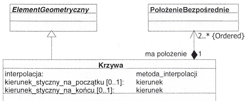
Rys. 4. Opis krzywej jako elementu geometrycznego (PN-N-12160)
