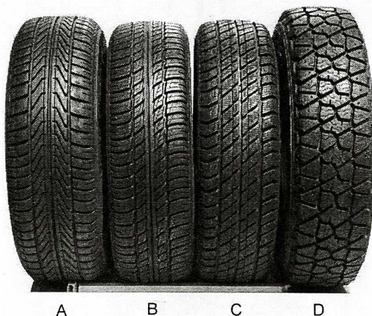
Rys. 2. Zestaw opon wykorzystywanych w badaniach metodą CPX Tyres used for CPX tests
