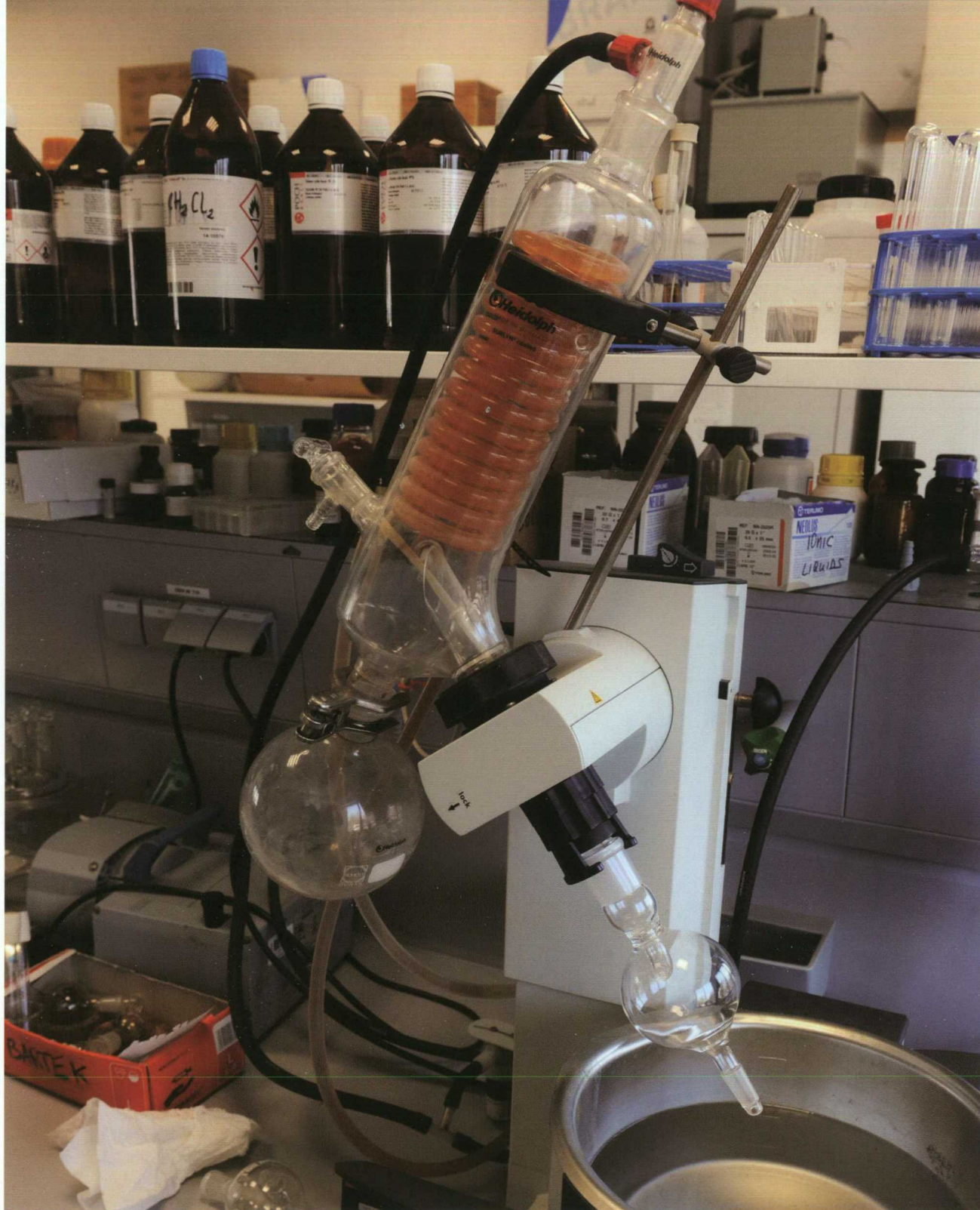
Wyparka, czyli ewaporator, sprzęt służący do kontrolowanego odparowywania cieczy, która była wykorzystywana na jednym z etapów projektu
