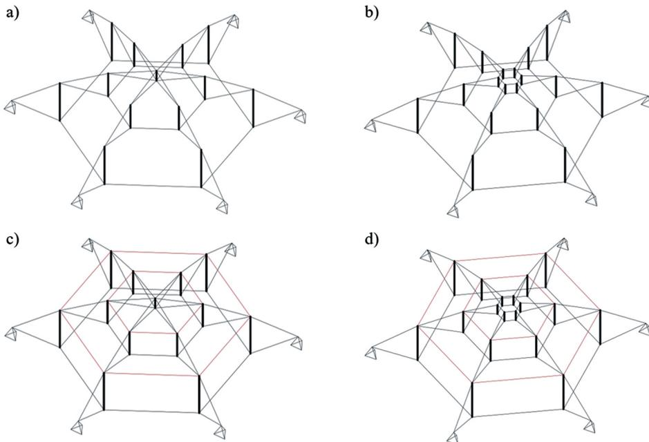
Fig. 2. Geiger domes: a) RG 6A, b) RG 6B, c) MG 6A, d) MG 6B
