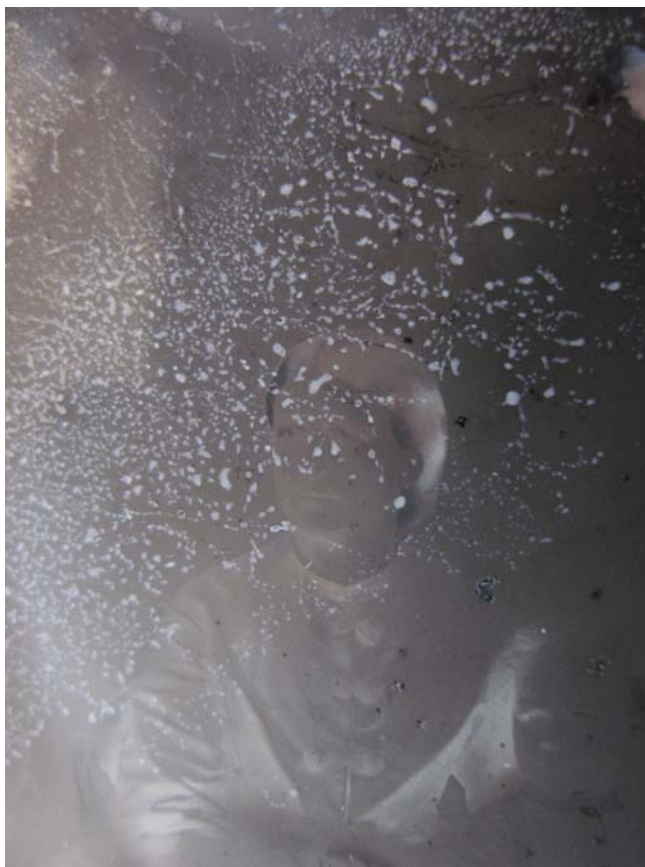
Il. 17. Efekt korozji szkła w postaci białych wysoleń
