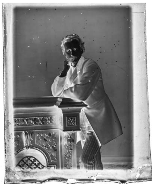
Il. 9. Przykład czarno-białego, wyrazistego obrazu fotograficznego w przezroczu negatywu kolodionowego (dostrzegalne również inne charakterystyczne cechy: nierówno przycięte szkło oraz zniszczenia obrazu fotograficznego – drobne odpryski i plamki)
