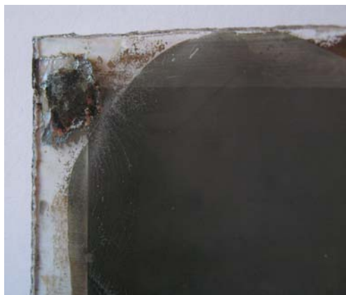
Il. 8. Niedbałe przycięcie brzegów szklanego podłoża negatywu charakterystyczne dla wielu tego typu obiektów (widoczne również resztki przyklejonego papieru oraz zniszczenia, m.in. wysolenia szkła)
