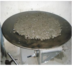
Fig. 3. Flow table test
