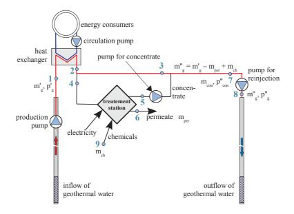
Fig. 2. Desalination of the partial stream of extracted geothermal water Rys. 2. Odsalanie części strumienia eksploatowanej wody geotermalnej
