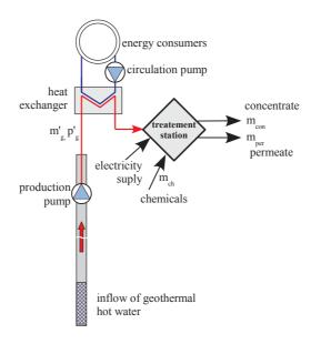
Fig. 1. Desalination of the entire stream of extracted geothermal water Rys. 1. Odsalanie całego strumienia eksploatowanej wody geotermalnej
