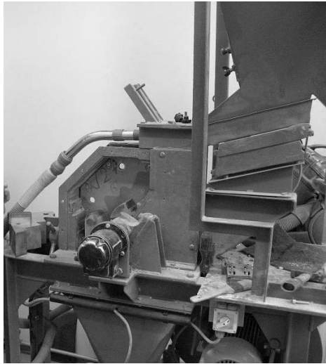
Rys. 2. Laboratoryjna kruszarka udarowa produkcji SBM MP (fot. T. Gawenda)
