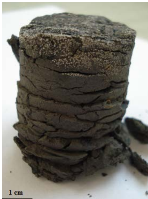
Fot. 3. Próbkę iłowca po bezpośrednim kontakcie z wodą
