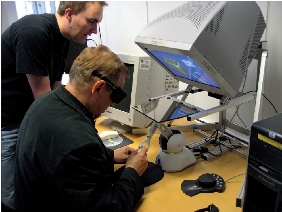
7. Phantom 3D – haptyczny manipulator pozwalający rzeźbić w voxelowej glinie wraz z projektorem obrazu trójwymiarowego, fot. J. Słyk 7. Phantom 3D – haptic manipulator allows for sculpting in voxel clay with a projector of three dimensional images, photo J. Słyk
