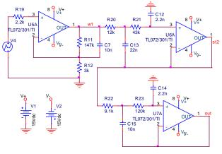
Fig. 12. ECG amplifier.
