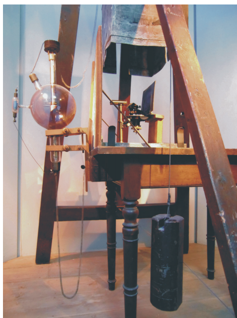
Ryc. 2. Aparatura, za pomocą której Walter Friedrich i Paul Knipping uzyskali obrazy dyfrakcyjne po przepuszczeniu promieni Röntgena przez kryształy (Muzeum Niemieckie, Monachium)
