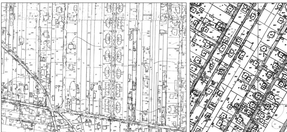
Ryc. 6. Gmina Michałowice. Nowa Wieś – zespół identycznych domków ustawionych szeregowo (16 bliźniaków) na działkach o wymiarach 22x21 m. Drogi prowadzone są po działkach rolnych. W Brwinowie małe działki wytyczone na działkach rolnych obsługiwane są przez ulice prywatne prowadzone często po obu stronach działki
